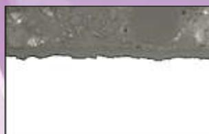
Lackschicht auf Stahl 1.4016 V=1000:1
