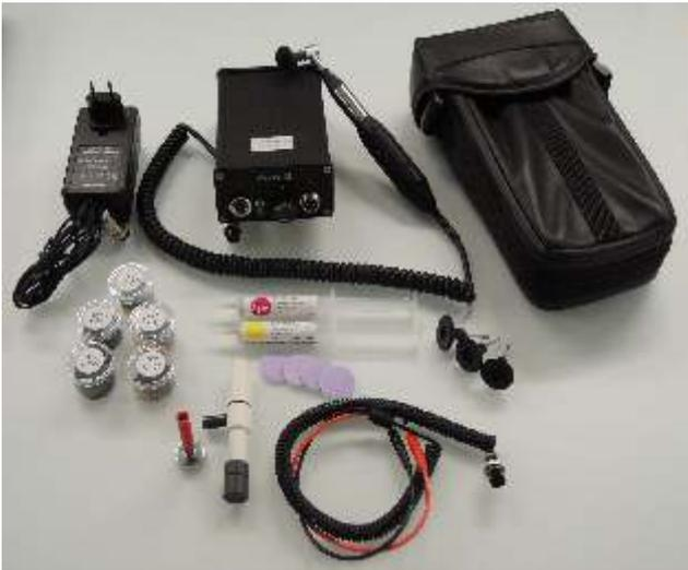
Minipol ist ein Gerätesystem für die ambulante Probenpräparation. Es dient zum mechanischen Schleifen und Polieren sowie zum elektrolytischen Ätzen. Minipol ist ein netzunabhängiges Stromversorgungsgerät mit hoher Leistung für den Betrieb von bürstenlosen Mikromotoren.
