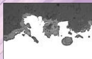
Korrosion an Federstahl 54SiCr 6 V=200:1
