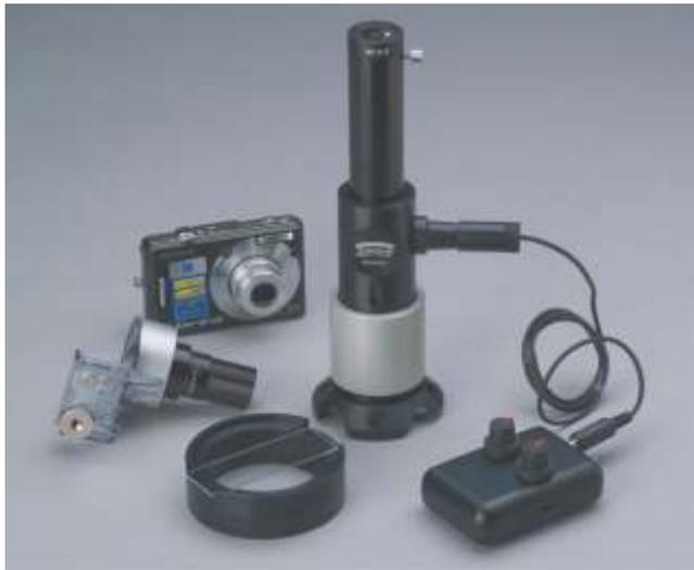
TKM ist ein hochwertiges Mikroskop für die ambulante (transportable) Metallographie. Es ist vorrangig bestimmt für die Betrachtung und Aufnahme metallographischer Schlitze an großen Teilen (z. B. in Gießereien) und Außenanlagen (Kraftwerke, Chemieanlagen usw.) sowie für Makrountersuchungen (visuelle Vor-Ort-Kontrolle).
